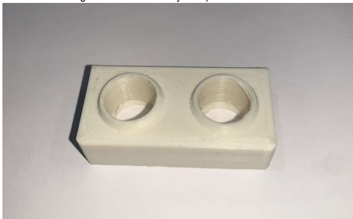
Figura 1 – Furos nos tijolos que formam dutos.
