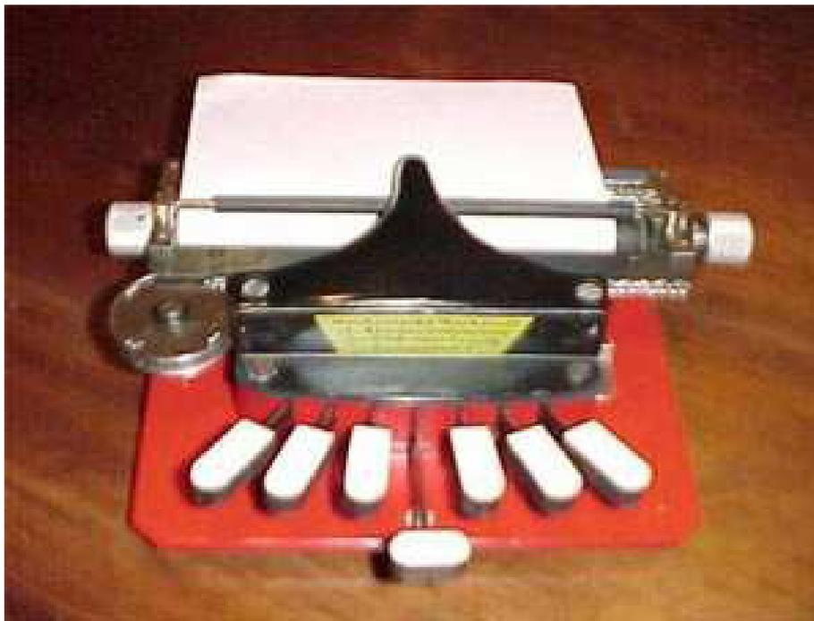
Figura 5.3 – Máquina Braille
